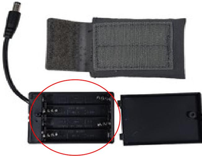
14) Le détail de la pochette de la batterie attachée au casque et connectée au ventilateur dans le masque au moyen de Velcro (le modèle peut varier).
